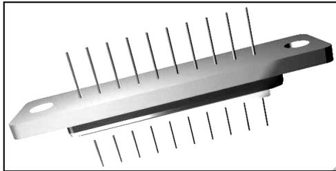
扁平电缆专用滤波阵列板采用 C 型滤波电路（同“螺装滤波阵列板”），其滤波针为方形针，与扁平电缆接头完全配合，连接可靠性很高，特别适用于使用扁平电缆的场合。滤波最佳范围在 1GHz 以下。
